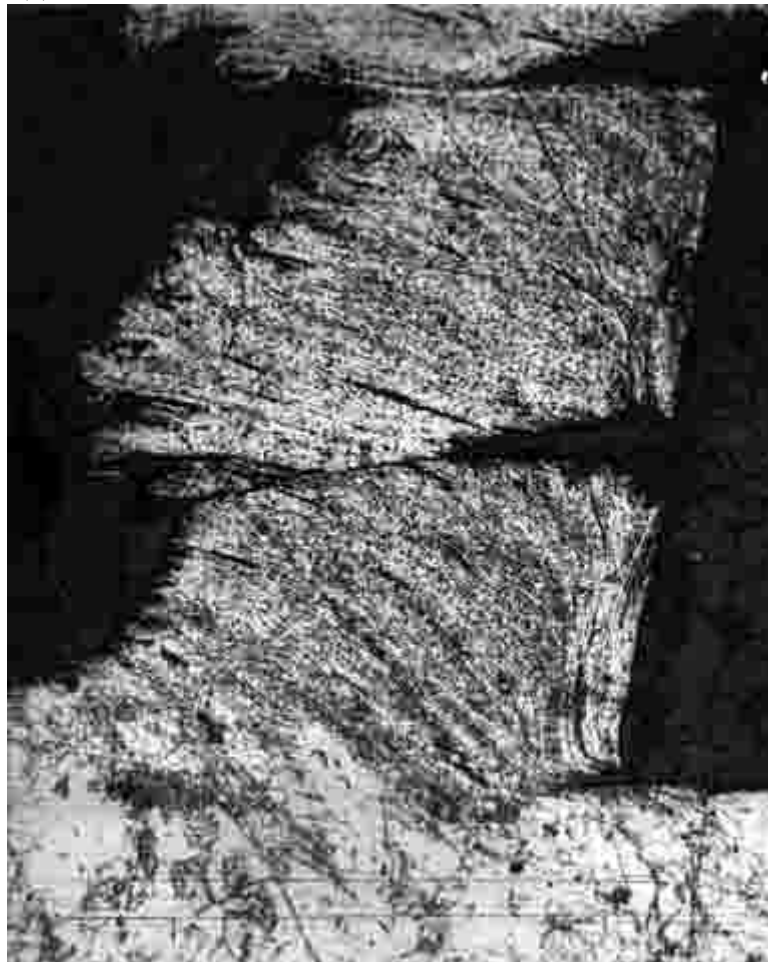
Рис. 4.1. Микрофотография корня стружки скалывания, полученного при резании коррозионностойкой стали 12X18H10T.
