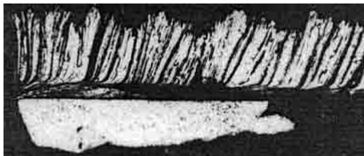
Рис.11.2. Микрофотография сливной стружки стали 12Х18Н10Т.
