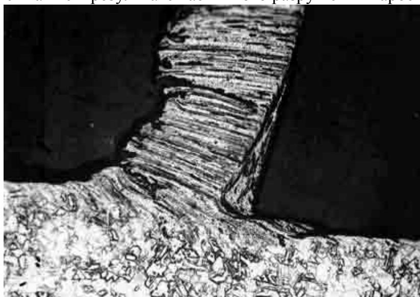
Рис.11.3. Корень стружки с наростом.
