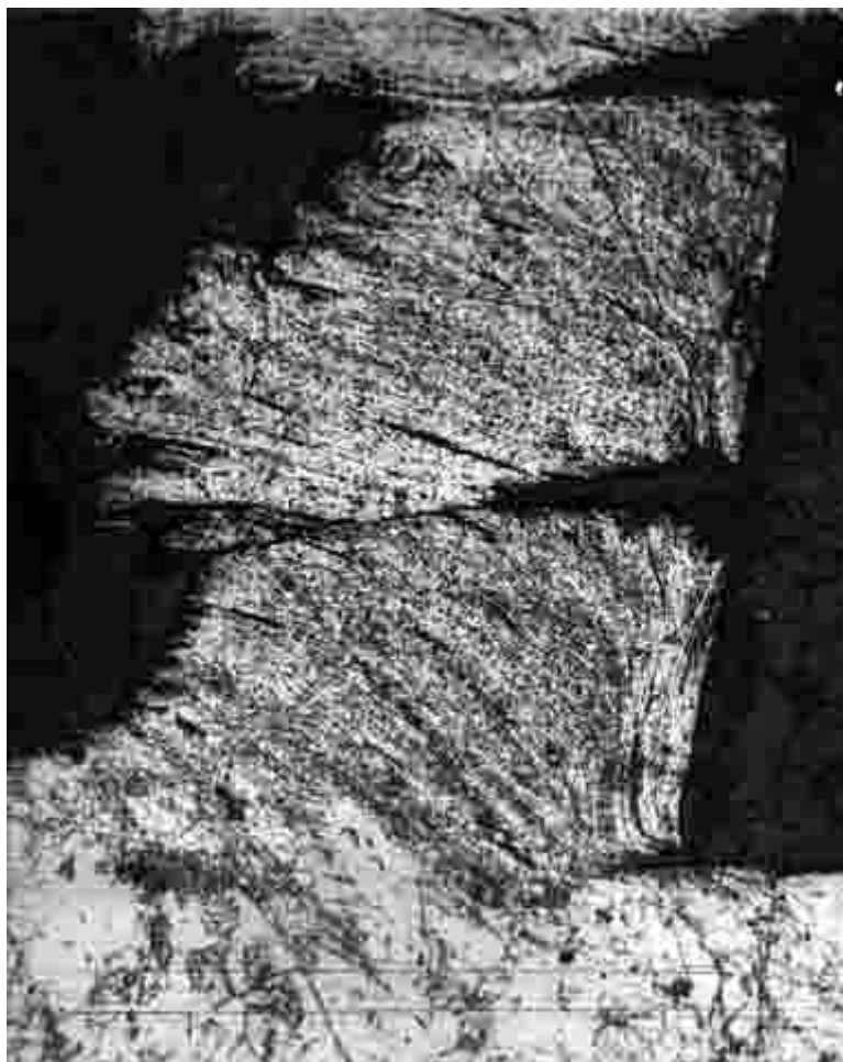
Рис.11.1. Микрофотография корня стружки скалывания, полученного при точении стали 12Х18Н10Т.
