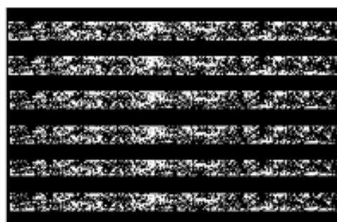
Рис. 2.42. Многослойная структура GaAs - GaAlAs, выращенная методом МВЕ (molecular-beam-epitaxi) - молекулярно-пучковой эпитаксии. Каждая темная полоска-6 атомных слоев GaAs, каждая светлая - 4 атомных слоя GaAlAs
